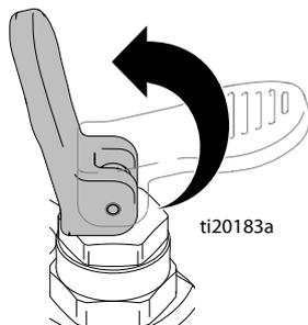
2. Извлеките блок вертикального рычага дозатора материала.
