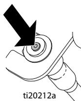
5. Для остановки устройства разметки нажмите кнопку распыления еще раз.
