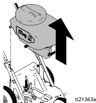
3. Извлеките два болта с помощью ключа и снимите кожух аккумулятора.
