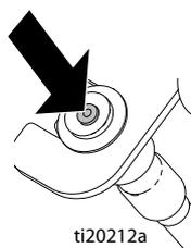
8. Установите клапан заправки/распыления в НИЖНЕЕ положение распыления.
