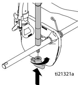
5. Установите блок внешнего распылительного щитка, сжав пружину и вставив щиток в горизонтальную D-образную планку.
