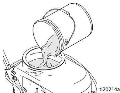
3. Для того чтобы наполнить устройство разметки жидкостью, нажмите кнопку распыления и дайте устройству разметки поработать, пока материал не начнет течь через заправочный шланг.
