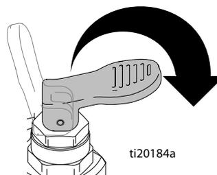
6. Разверните распылительный наконечник в положение ОЧИСТКИ, осуществляйте распыление в течение двух секунд, затем остановите распыление.
