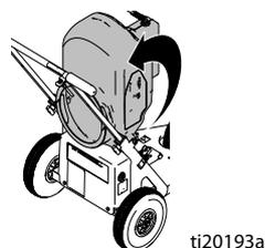
3. Очистите внутреннюю поверхность бункера водой. Наклоните бункер назад и распылите воду на внутреннюю поверхность.
