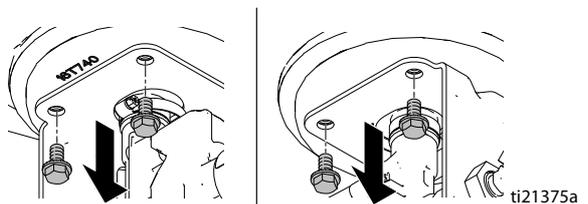
11. Извлеките бункер из блока насоса/двигателя.
