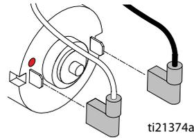
8. С помощью ключа ослабьте крепление перегородки и отсоедините шланг.
