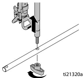
3. Установите блок внутреннего распылительного щитка, сжав пружину и вставив щиток в горизонтальную D-образную планку.
