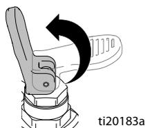
2. Разверните наконечник распылителя в положение **ОЧИСТКИ**.
