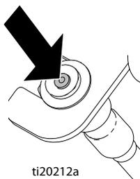
4. Подключите зарядное устройство к устройству разметки. См. раздел **Зарядка аккумулятора**, стр. 6. Перед хранением полностью зарядите аккумулятор и отключите зарядное устройство.
