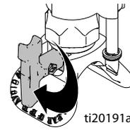
8. Установите клапан заправки/распыления в **НИЖНЕЕ** положение распыления.
