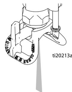
7. Для снятия давления установите клапан заправки/распыления в ВЕРХНЕЕ положение. Затем разверните наконечник обратно в положение распыления.
