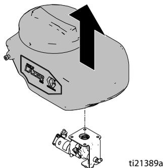
12. Извлеките блок насоса/двигателя.
