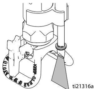
4. Остановите устройство разметки, нажав кнопку распыления.
