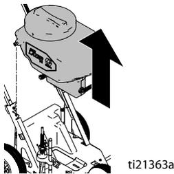
4. Извлеките два болта с помощью ключа и снимите кожух аккумулятора.
