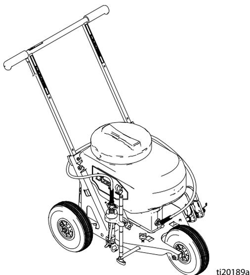
3. Для регулировки ширины линии настройте высоту наконечника (поднятие наконечника увеличивает ширину линии).
