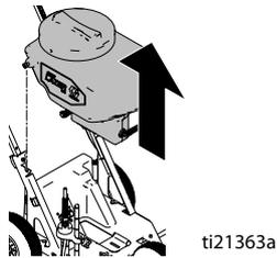
3. Извлеките два болта с помощью ключа и снимите кожух аккумулятора.
