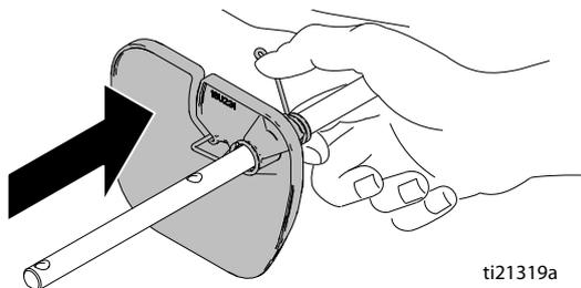
4. Установите блок вертикального рукава дозатора материала.
