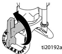
3. Установите клапан заправки/распыления в **НИЖНЕЕ** положение распыления.
